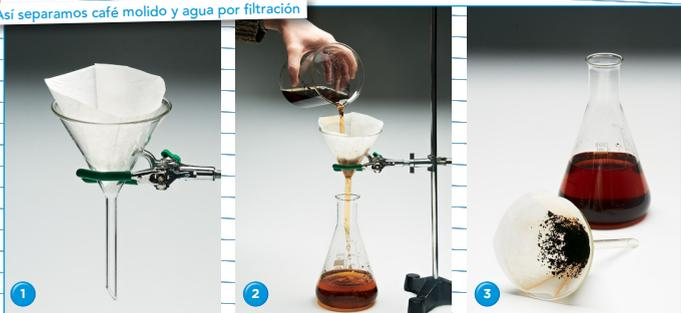
1 Para filtrar, se coloca el papel de filtro dentro de un embudo y se sujeta con un aro metálico.
