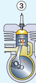
3 Tiene lugar la explosión de la mezcla en el cilindro, ayudada por la chispa que produce la bujía.
